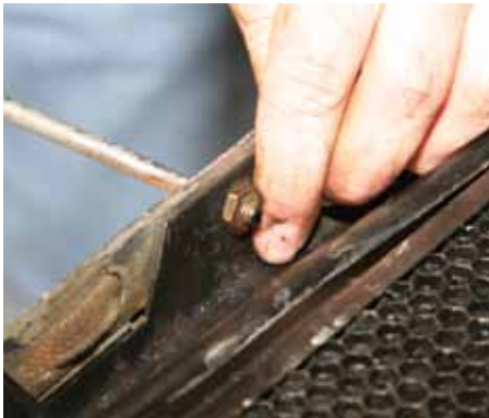
Zuerst wird der Kühler ausgebaut und von seiner verchromten Maske befreit
