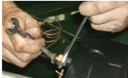
Immer schön gehalten, sonst bricht die Leitung des Fernthermometers ab
