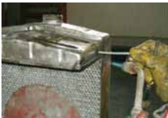
Dann wird auch der obere Wasserkasten am Netz festgelötet
