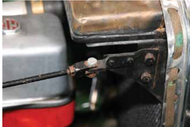
Über diese Längsstrebe wird der Abstand zwischen Kühler und Spritzwand eingestellt. Das klappt nur, wenn der Kühler genau gerade auf seinem Trägerrahmen sitzt
