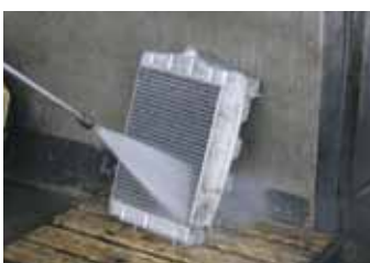
Mit Hochdruck werden die letzten Flussmittelreste weggeblasen
