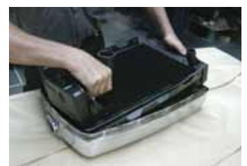
Sobald der Speziallack trocken ist, kommt die Maske drüber
