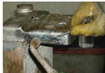
Nun lötet der Kühlerbauer die Nähte des Kastens endgültig dicht
