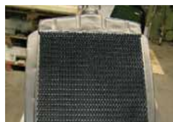
Dann wird der Kühler zur besseren Wärmeableitung schwarz lackiert
