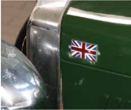
Dank eines lausig eingepassten Kühlers sitzt auch die Motorhaube unseres MG J2 schlecht
