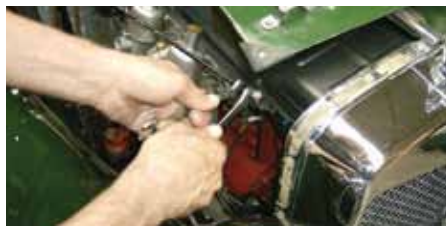
Die letzte Feineinstellung erfolgt über die variablen Längsstreben
