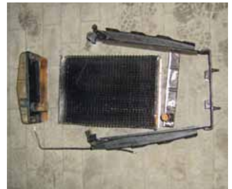
Separiert: Die beiden Wasserkästen, das Netz und der Trägerrahmen gehen getrennte Wege
