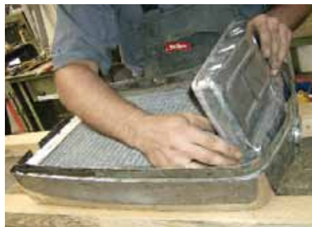
Vor dem Anlöten der Kästen probiert er mit den losen Teilen aus, ob die Chrommaske passt
