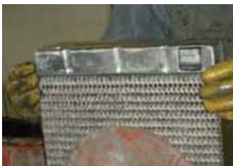
Dann setzt der Fachmann von oben den unteren Wasserkasten auf...
