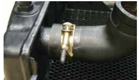
Baumarkt, nein danke: So muss eine Schlauchschelle am Vorkriegsauto aussehen!
