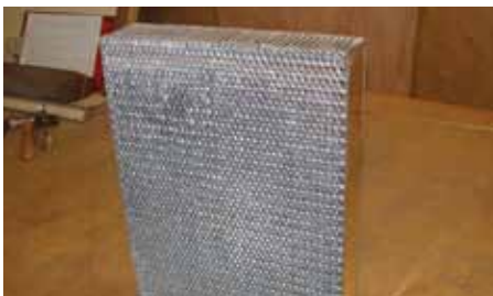
Das Netz wird von beiden Seiten in flüssiges Zinn getaucht und so abgedichtet
