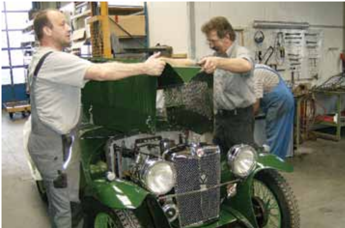
Ein Fall für Zwei: Um den Kühler endgültig ausrichten zu können, muss nun die vierteilige Motorhaube aufgelegt werden
