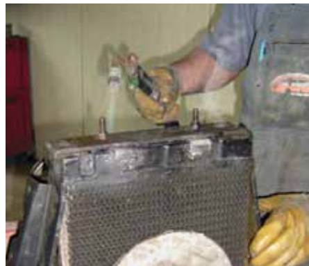
Mit der Lötlampe wird der Trägerrahmen so lange erhitzt, bis er sich vom Netz löst
