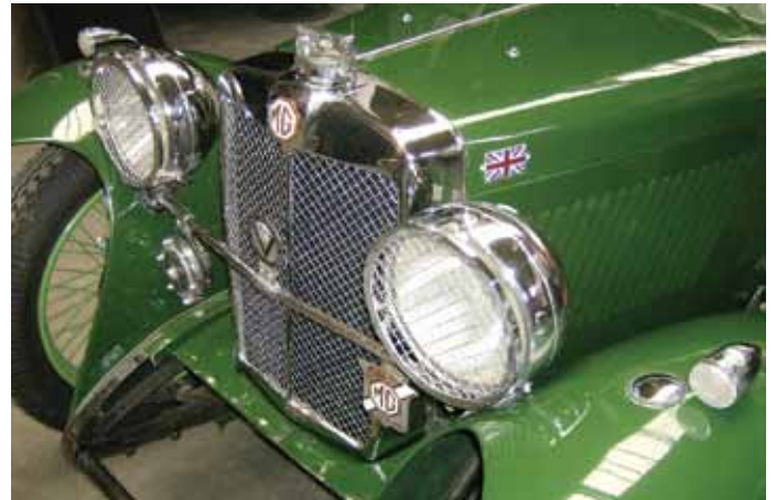
Passt perfekt: Das Spaltmaß ist rundherum gleichmäßig
