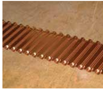
Eine alte Prägemaschine drückt diese Struktur ins Kupfer
