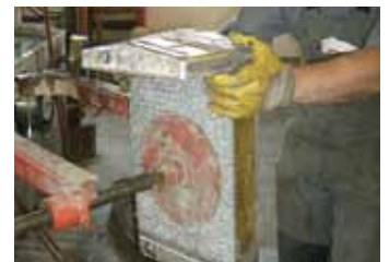
Bevor der obere Kasten verlötet wird, richtet er ihn exakt aus
