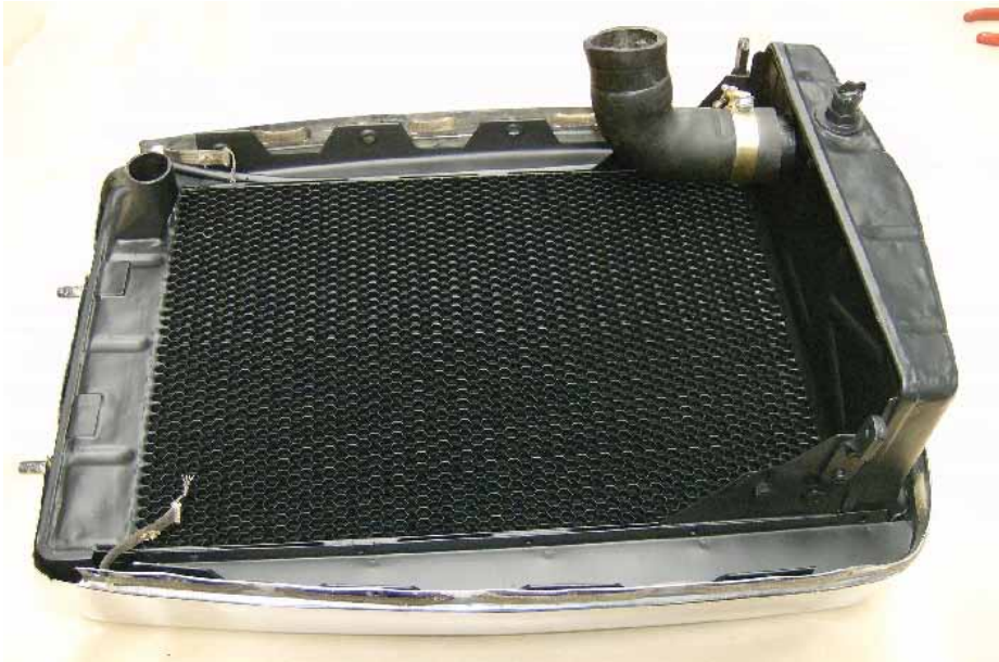
Gutes Zeichen: Auch ohne Verschraubung verlaufen die Windleitbleche genau entlang der Chrommaske. Weder unten noch oben am Einfüllstutzen ergeben sich Druckstellen
