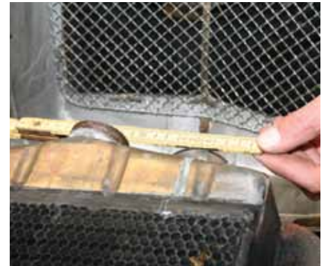
Der Kühlerbauer notiert alle Ursprungsmaße, damit er später korrigieren und anpassen kann
