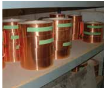
Unser Wabenkühler wird aus solchen Kupferblechstreifen gemacht
