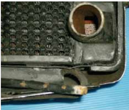
Ein erster Blick in Innere zeigt, dass der Kühler vor ein paar Jahren bereits „restauriert“ wurde
