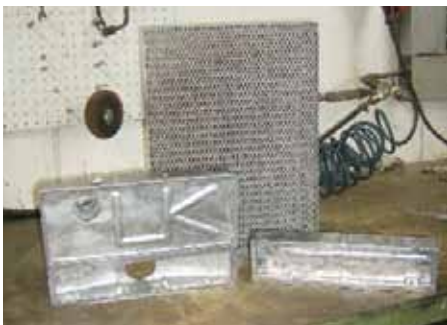
Die beiden Wasserkästen werden wieder zusammengelötet und komplett verzinkt
