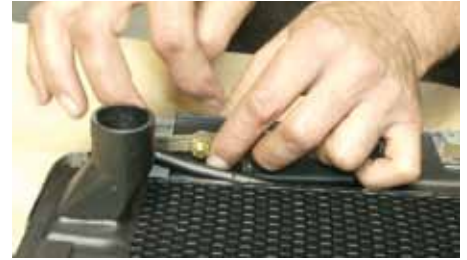
Mit originalgetreuen Messingschrauben wird die Maske nun am Rahmen befestigt
