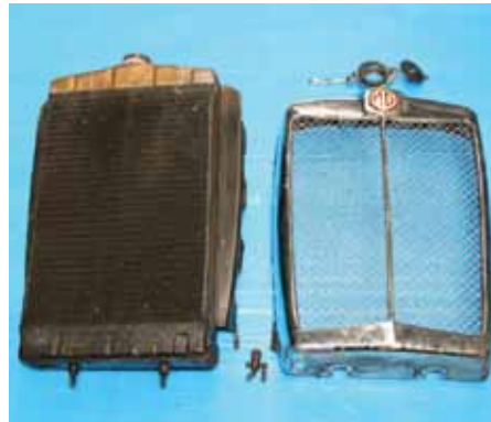
Erst jetzt wird der Trägerrahmen mit den seitlichen Windleitblechen sichtbar
